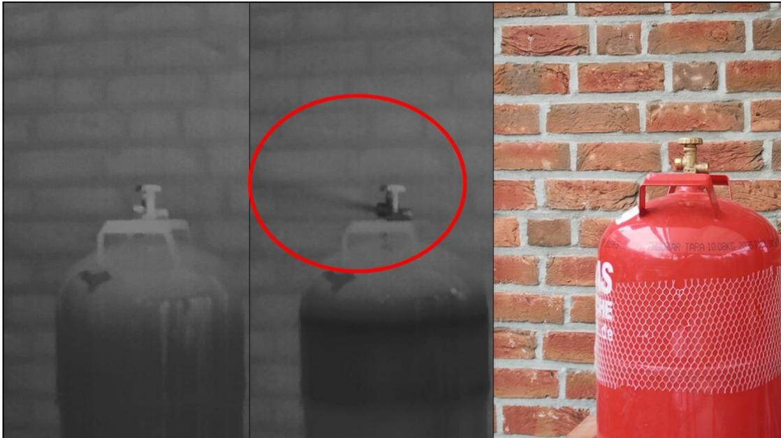
**Abbildung 11:** Einfache Gasdetektion mittels einer DJI Mavic 2 Enterprise Advanced Drohne. Links = Temperatur der Flasche im Normalzustand, Mitte = Abkühlung der Luft und des Ventils bei Gasaustritt sichtbar im thermalen Infrarotbild (dunkel), Rechts = Gasaustritt im gleichzeitig aufgenommenen RGB-Video nicht sichtbar.
