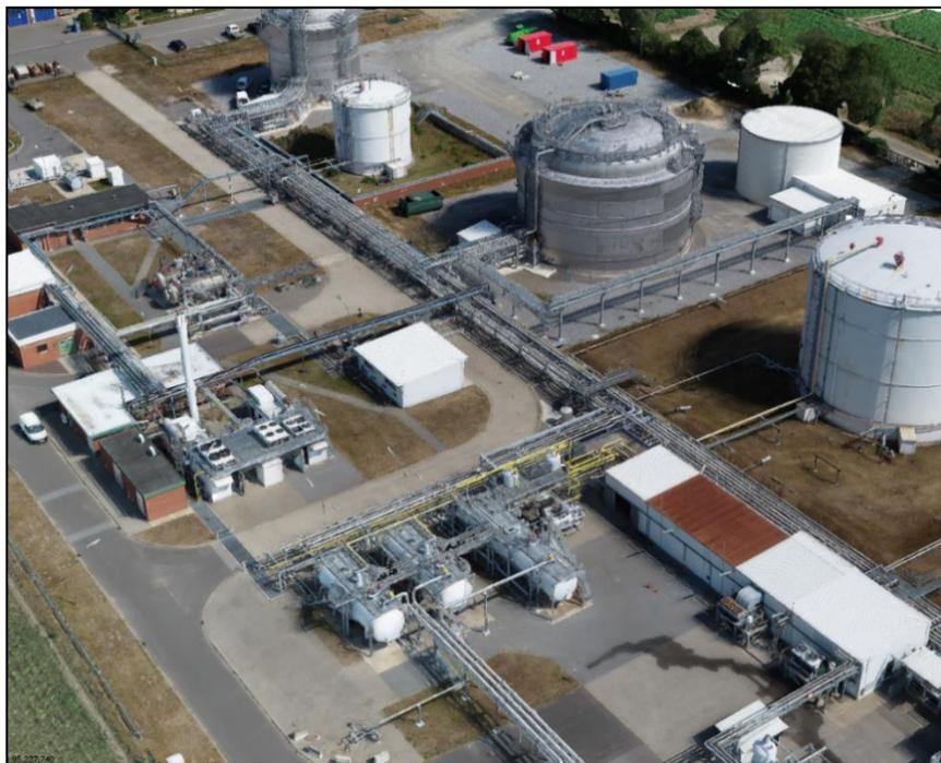
**Abbildung 10: Interaktives, texturiertes 3D-Modell einer gastechnischen Anlage, erstellt aus Aufnahmen einer DJI Phantom 4 RTK; Photogrammetriesoftware Agisoft Metashape (Haske 2021). Die Phantom 4 Multispectral wurde zur Validierung der Sentinel-Daten im Bereich Vegetationsmonitoring sowie zur Klassifikation von Oberflächen genutzt.**
