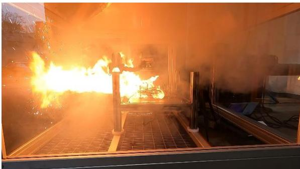
**Abbildung 10:** Jet Flame während des Thermal Runaways einer 10.000 mAh-Pouch-Zelle im Demonstrator (Janßen & Saupe 2023)
