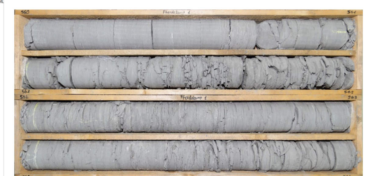
Abb. 4: Bohrkerns der Bohrung Pferdekamp 1 aus dem Tiefenintervall 560 m (oberster Kern) bis 564 m (unterster Kern) (GD NRW).
